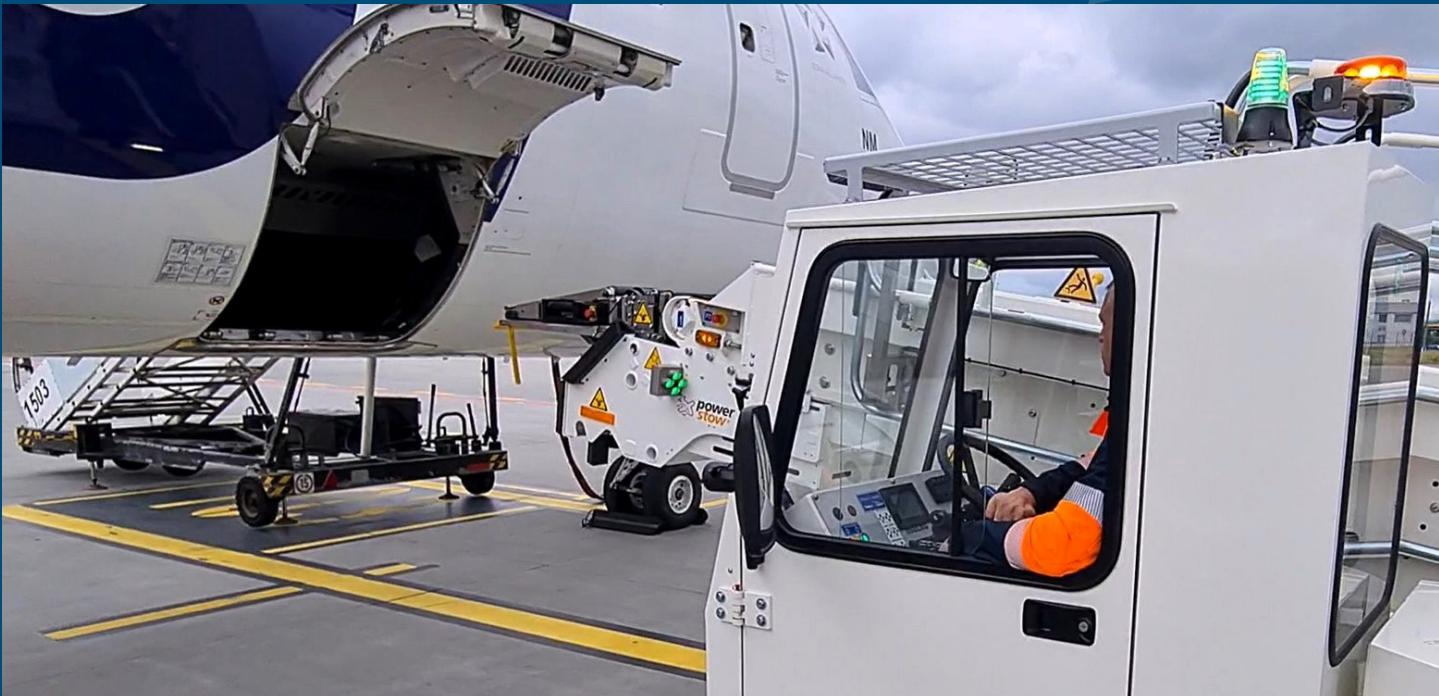
安全靠机辅助系统是一种飞机防损系统，旨在提高靠泊飞机的安全性和效率。该系统辅助驾驶员安全地接近飞机，并将伸缩滚动传送带靠泊在飞机货舱的门框上。它基于先进的激光雷达技术，符合 IATA AHM 913 的标准。
